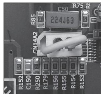
**Примечание:** Подключение ФВЧ выполняется по каждому усилительному модулю DM-300 индивидуально.
