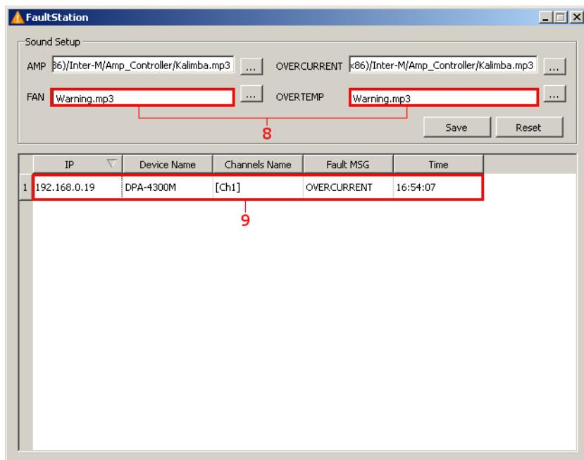
9. При возникновении ошибки появляется системное модальное окно, в котором указывается время возникновения, тип ошибки, IP-адрес и название усилителя, а также номер усилительного модуля DM-300 (номер канала). Информация дублируется в списке ошибок, отображаемом в окне FAULT STATION.
